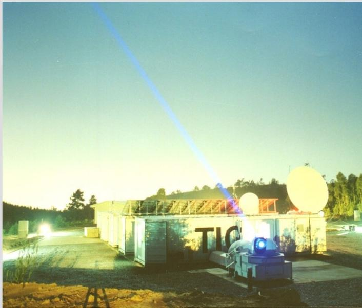
VLBI: antena de 6 metros (transportable) con banda S/X
